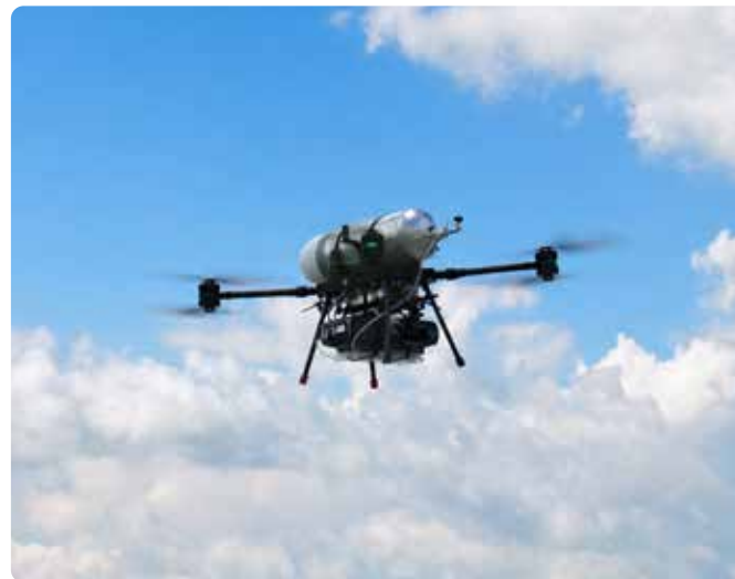
Die LH 2 -Drohne des ZAL bei ihrem erfolgreichen Erstflug im Juli 2026. Gut erkennbar: der zylindrische Flüssigwasserstofftank.
