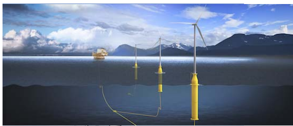
Floatings: schwimmende Windkraftträder für den Einsatz auf hoher See (Bild: DNV GL)
